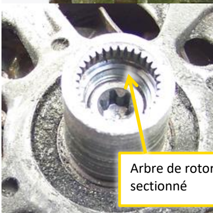
Dommages dus au feu, à la rouille ou à l'oxydation
