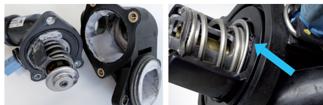
Figure 2 : Produits d'étanchéité, corps étrangers et résidus entraînent des dysfonctionnements et des colmatages du thermostat
