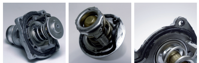
Abbildung 1: Thermostate mit zusätzlicher Dichtmasse
