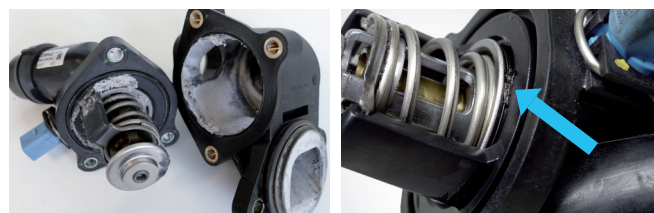
Иллюстрация 2: Герметик, посторонние частицы и отложения приводят к неисправностям и блокированию термостата
