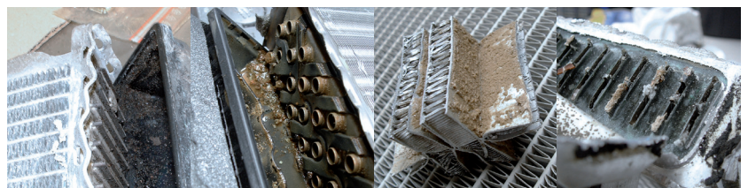
Abbildung 2: Ablagerungen wie Rost, Kalk, Dichtmittel oder andere Fremdkörper sorgen für Blockaden und reduzieren die Kühlleistung
