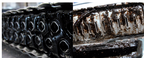
Иллюстрация 1: Разложение резиновых прокладок под действием масла
