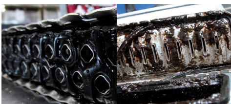
Abbildung 1: Durch Öl zersetzte Gummidichtungen
