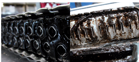
Zdjęcie 1: Uszczelki gumowe zniszczone przez olej
