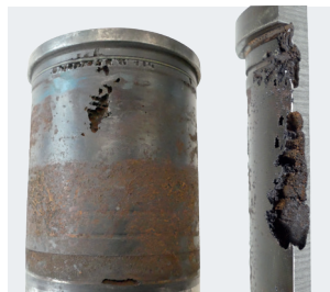
Ilustracja 2: Tuleja cylindrowa ze szkodą kawitacyjną w okolicy górnego martwego punktu
