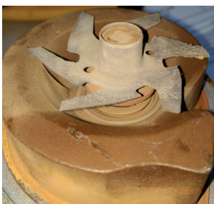
Εικόνα 1: Πτερύγιο αντλίας ψυκτικού μέσου φθαρμένο λόγω σπηλαιώσης
