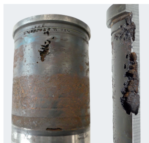
Εικόνα 2: Χιτώνιο με βλάβη λόγω σπηλαιώσης στην περιοχή του άνω νεκρού σημείου
