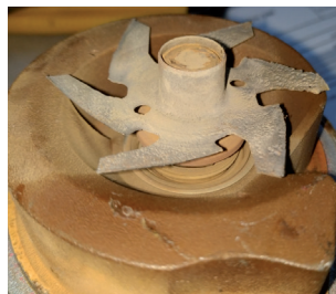
Ilustracja 1: Łopatki pompy chłodziwa starte wskutek kawitacji
