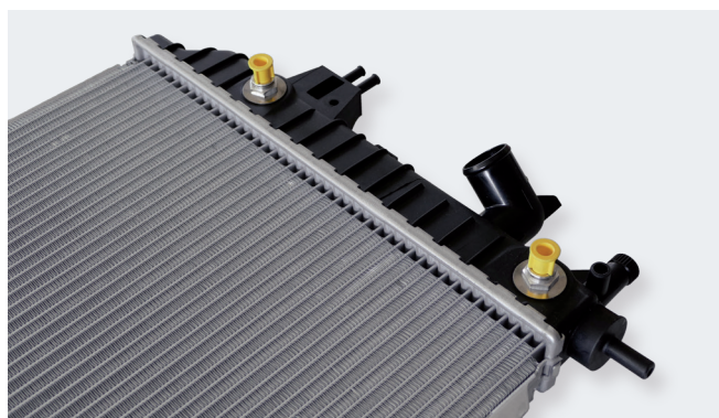
Abbildung 2: Verschlussstopfen auf den Anschlüssen des Ölkühlers
