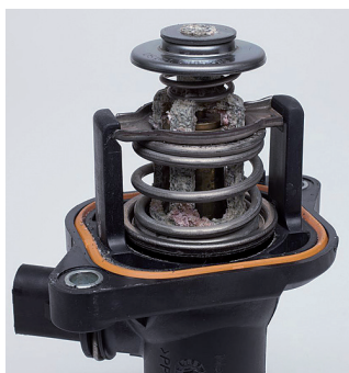
Figura 1: Señales claras de corrosión en un termostato electrónico (tipo TM).
