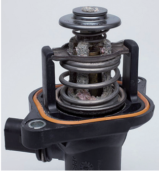
Resim 1: Elektronik kontrollü bir termostatta (TM tipi) gözle görülür korozyon izleri
