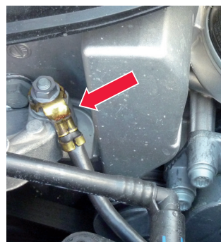
Figure 3 : Vérifiez le branchement correct et l'état du câble de masse.
