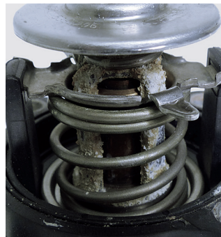
Εικόνα 2: Μέσω μη εγκεκριμένων πρόσθετων ψυκτικών μέσων, το αλουμίνιο αποσυντίθεται κανονικά.
