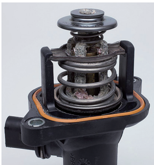
Abbildung 1: Deutliche Korrosionsspuren an einem Kennfeld-Thermostat (Typ TM)
