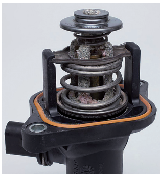
Εικόνα 1: Σαφή ίχνη διάβρωσης σε ένα θερμοστάτη χαρακτηριστικού πεδίου (τύπος TM)
