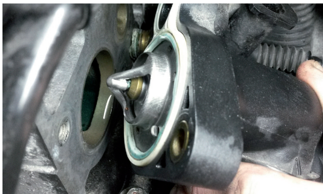
Figure 1 : À l'ouverture du circuit de refroidissement, l'eau de refroidissement s'en échappe et de l'air s'y introduit.
