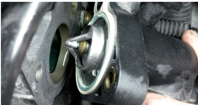
Рисунок 1: После размыкания охлаждающего контура: охлаждающая жидкость выходит наружу, а воздух поступает внутрь системы.
