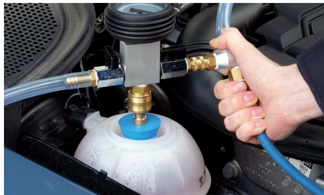
Figure 3 : Le système crée une dépression dans le circuit par l'effet Venturi.
