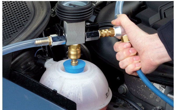
Resim 3: Venturi etkisi aracılığıyla sistemde bir vakum oluşur.
