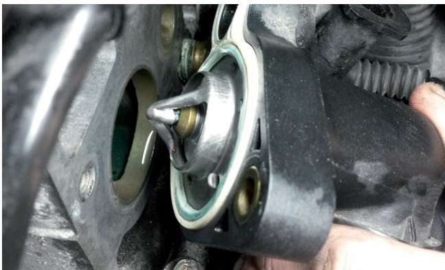
Abbildung 1: Wird der Kühlkreislauf geöffnet, tritt Kühlwasser aus und Luft in das System ein.
