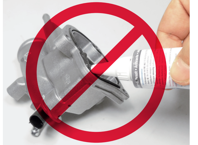
Resim 3: Ek sızdırmazlık maddeleri contalara hasar verebilir ve işlevlerini sınırlayabilir.
