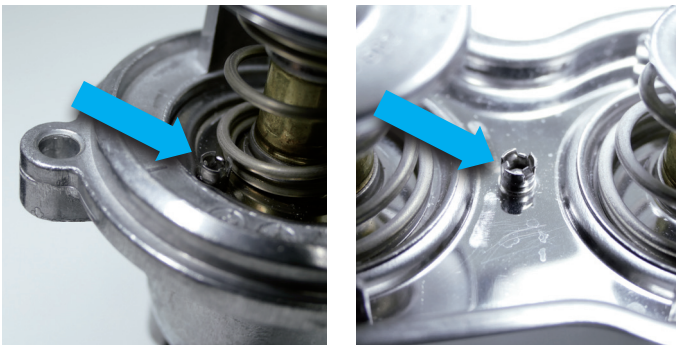
Figuras 1 y 2: Válvulas esféricas (flecha) en el plato del termostato en distintos modelos de termostato
