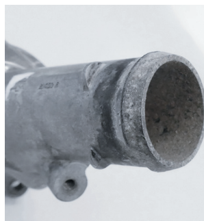
Abbildung 3: Korrodierte Flächen vor dem Zusammenbau sorgfältig reinigen
