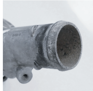
Resim 3: Parçaları birleştirmeden önce, korozyona uğramış yüzeyleri özenli bir şekilde temizleyin
