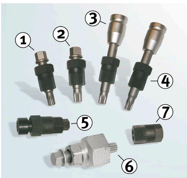
Obrázek 5: Potřebné speciální nářadí pro demontáž a montáž různých rovnoběžných řemenic
