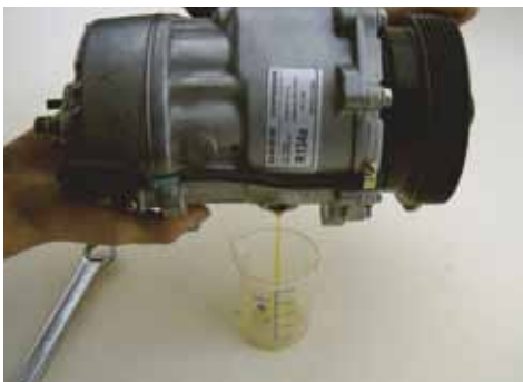
4. Kompressor vollständig entleeren, Kupplung dazu drehen
