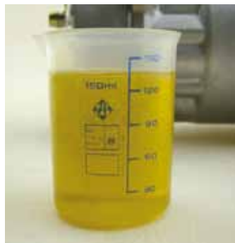
5. Vorhandenes Öl im Messbecher auffangen bzw. abmessen
