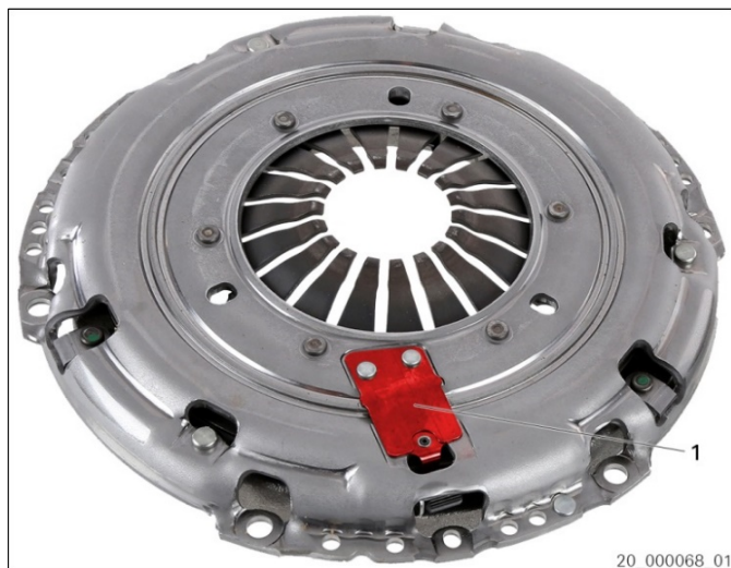
Sl. 7: XTend, tip IV z zaporno pločevino (zakovičeno)
