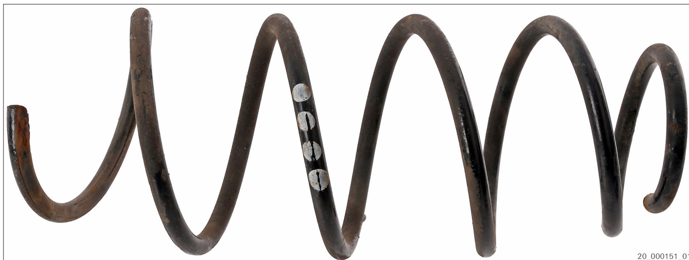
Фиг.2 Използвани пружини на ходвата част с цветна маркировка (пример)
