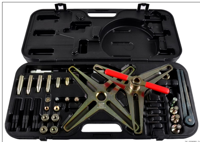
Фиг. 8: специализиран инструмент: затягащо устройство с центриращ дорник
