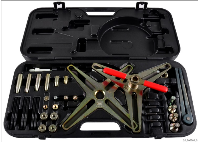
图8: 专用工具——带定心轴的夹紧装置
