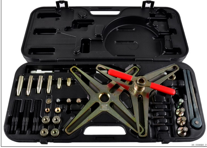
Şek. 8: Özel el aleti: Merkezleme malafalı gerdirme tertibatı
