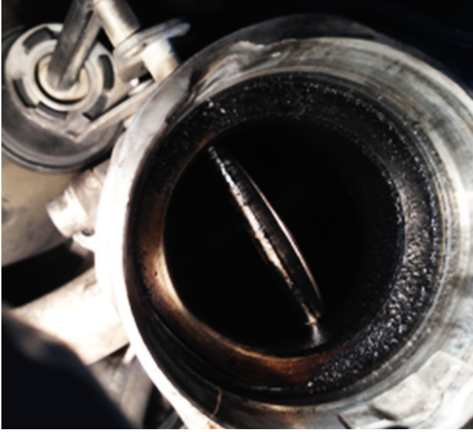
Resim 4: Egzoz Gazı Resirkülasyon valfi (EGR valfi) kurumlanmış
