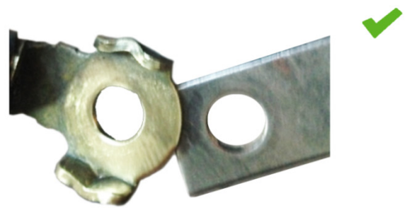
Fig. 1: Legătura la masă înainte de curățare: contact imperfect Fig. 2: Legătura la masă după curățare: contact bun
