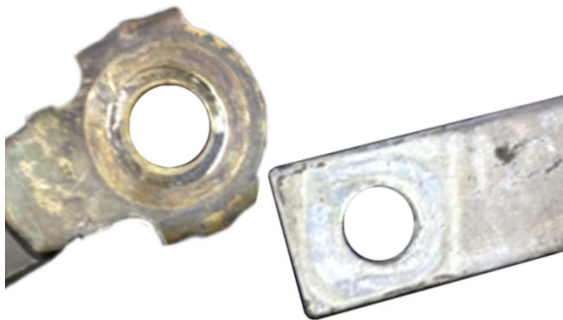
Εικ. 1: Σύνδεση γείωσης πριν τον καθαρισμό: κακή επαφή
