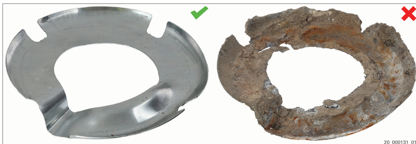
Rys. 3 Anoda protektorowa nowa | Anoda protektorowa zużyta
