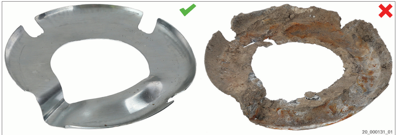
Obr. 3 Nová protikorózna anóda | Použitá protikorózna anóda
