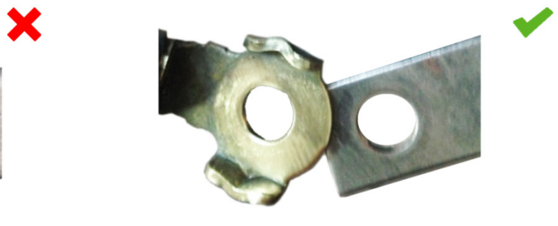
Obr. 2: Uzemnenie po očistení: kontakt dobrý
