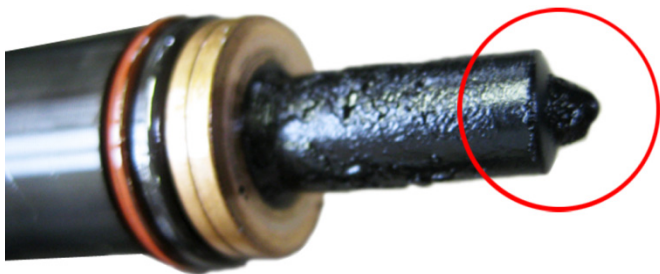
Obr. 3: Jednotka vstrekovania paliva zanesená karbónom
