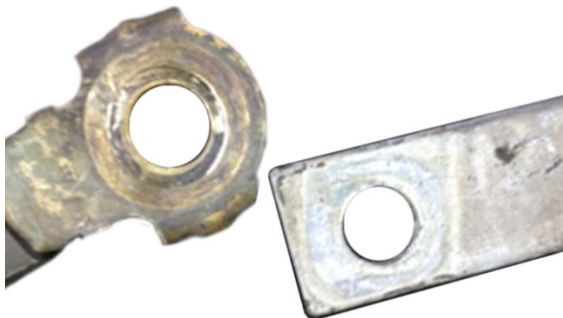
Obr. 1: Uzemnenie pred očistením: kontakt zlý
