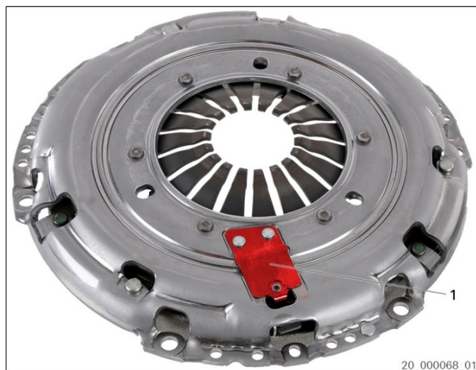
7. ábra: IV. típusú XTend zárólemezzel (rászegecselve)
