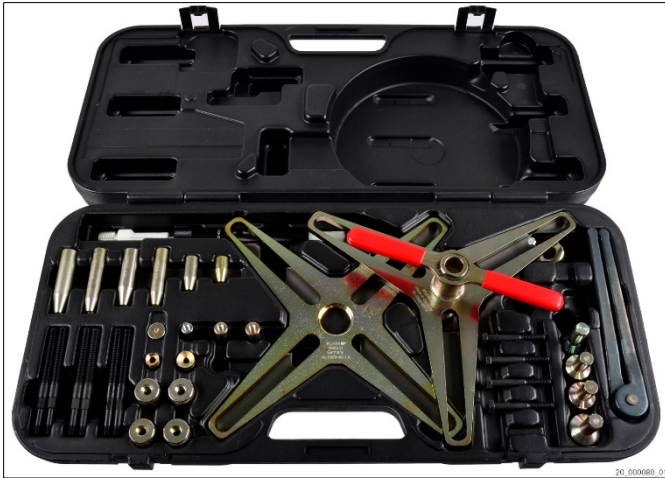
8. ábra: Különleges szerszám: központosító tuskéval ellátott szorítókészülék
