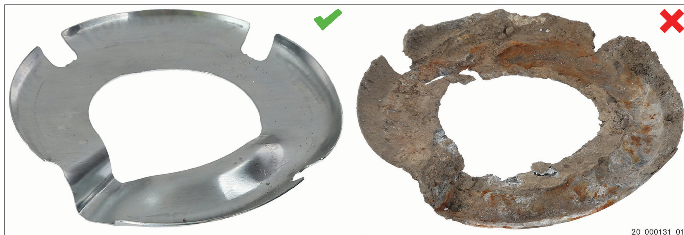
Fig. 3 Ny offeranode | Brugt offeranode
