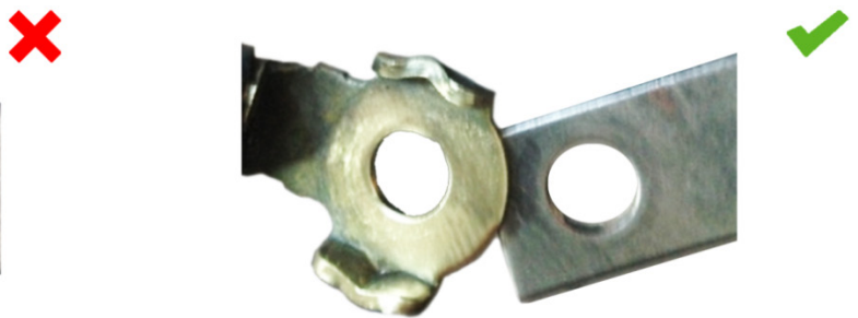
Afb. 2: Massaverbinding na de reiniging: contact goed
