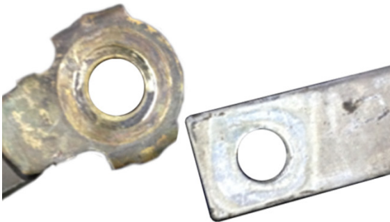
Afb. 1: Massaverbinding vóór de reiniging: contact slecht
