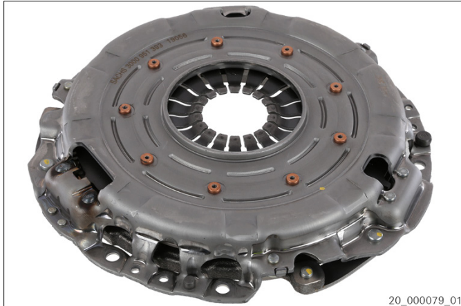
Fig. 4: XTend Tipo III sin pieza de bloqueo
