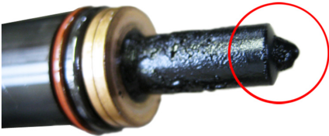
Fig. 3: elemento bomba-inyector carbonizado
