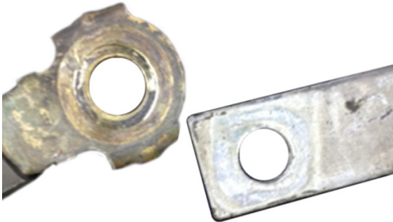
Fig. 1: conexión a masa antes de la limpieza: mal contacto
