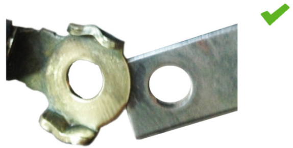
Fig. 2: conexión a masa después de la limpieza: buen contacto
