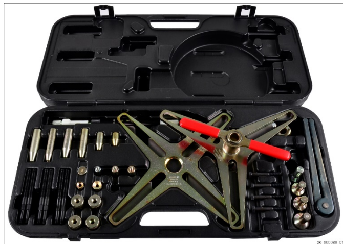
Fig. 8 : outil spécial : dispositif de serrage avec mandrin de serrage
