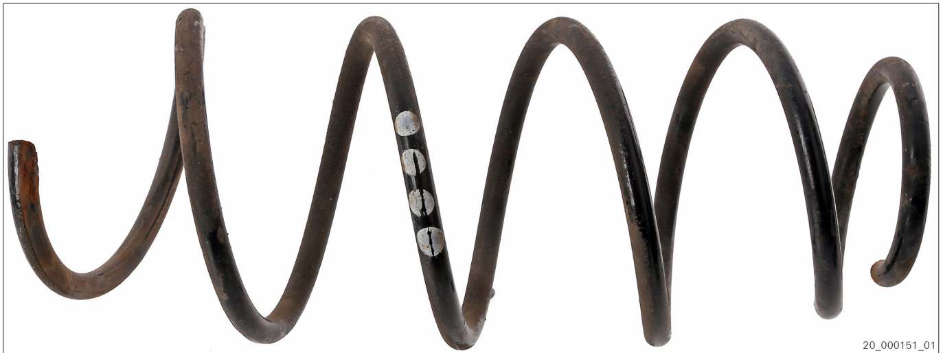
Abb. 2 Gebrauchte Fahrwerksfeder mit Farbmarkierung (Beispiel)
