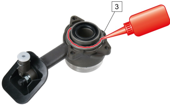
Fig. 2: Dichtmittel auf Anlagefläche (3) des CSC auftragen / Apply sealing compound to the contact surface (3) of the CSC / Appliquer le produit d'étanchéité sur la surface d'appui (3) de la butée hydraulique / Coloque sellante en la superficie de contacto (3) del CSC
