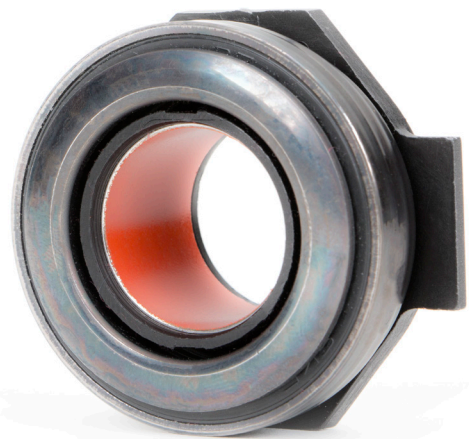
3. ábra: A PTFE-perselyes kinyomócsapágyat nem szabad kenőanyaggal ellátni
