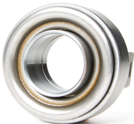
1. ábra: A fémperselyes kinyomócsapágyat el kell látni kenőanyaggal
