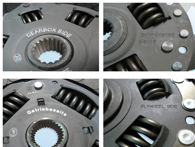
Зображення 1–4: можливі маркування диска зчеплення
