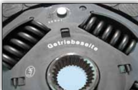
Slika 1-4: Možne oznake na lameli sklopke
