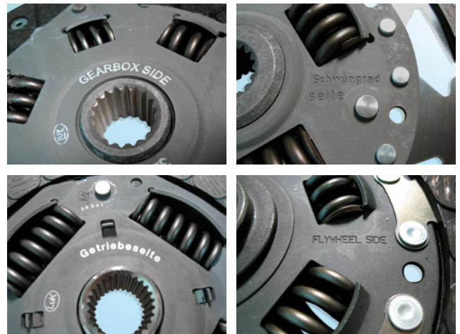
Figura 1-4: possibili scritte presenti sul disco frizione
