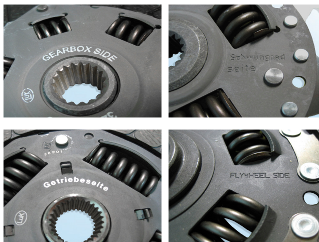
Снимка 1-4: Възможни маркировки на диска на съединителя
